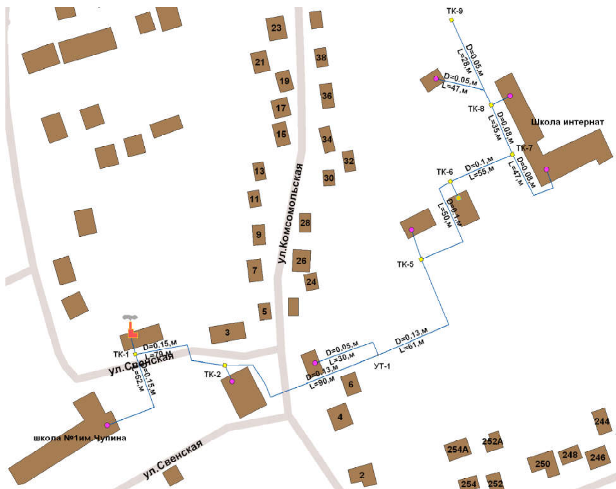
Схема тепловых сетей от котельной ул. Школьная, 10
