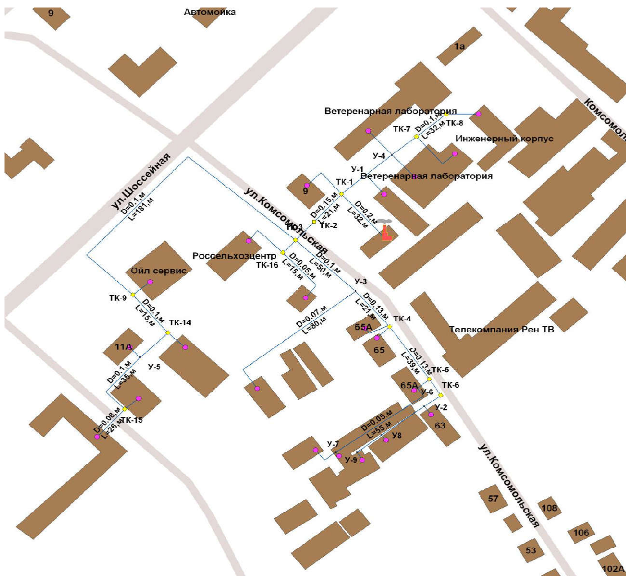
Схема тепловых сетей от котельной ул. Комсомольская, 67
