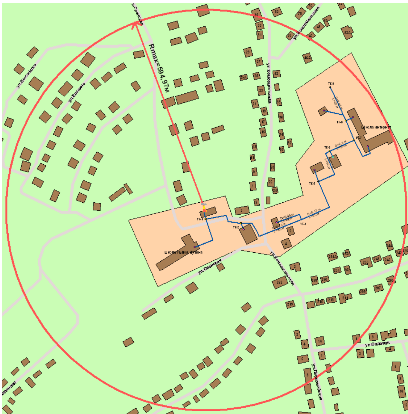
Рис. 2 Радиус эффективного действия котельной ул. Школьная, 10
