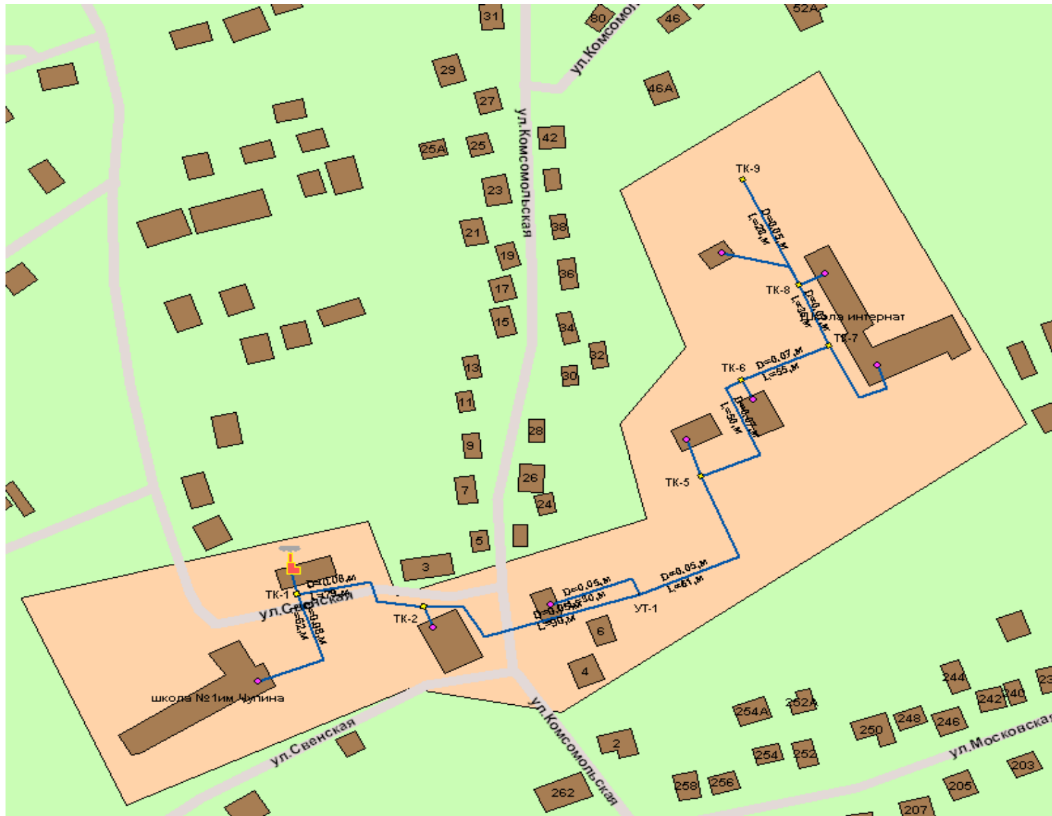
Рис. 2 Зона теплоснабжения котельной ул. Школьная, 10
