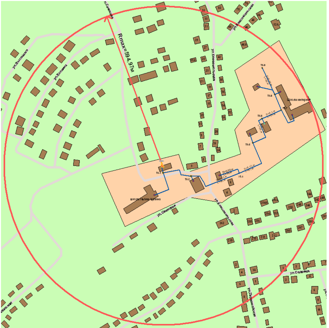
Рис. 9 Радиус эффективного действия котельной ул. Школьная, 10
