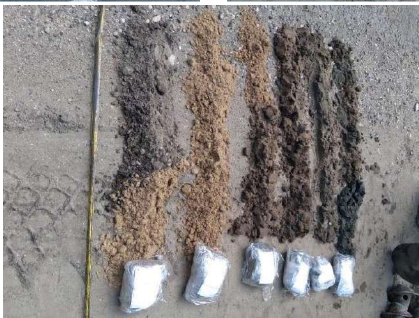
Выкладка керна из скважины осуществлялась с 1 по 6 метр.
