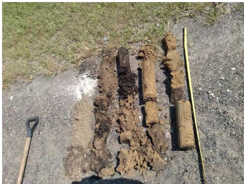
Выкладка керна из скважины осуществлялась с 1 по 5 метр.
