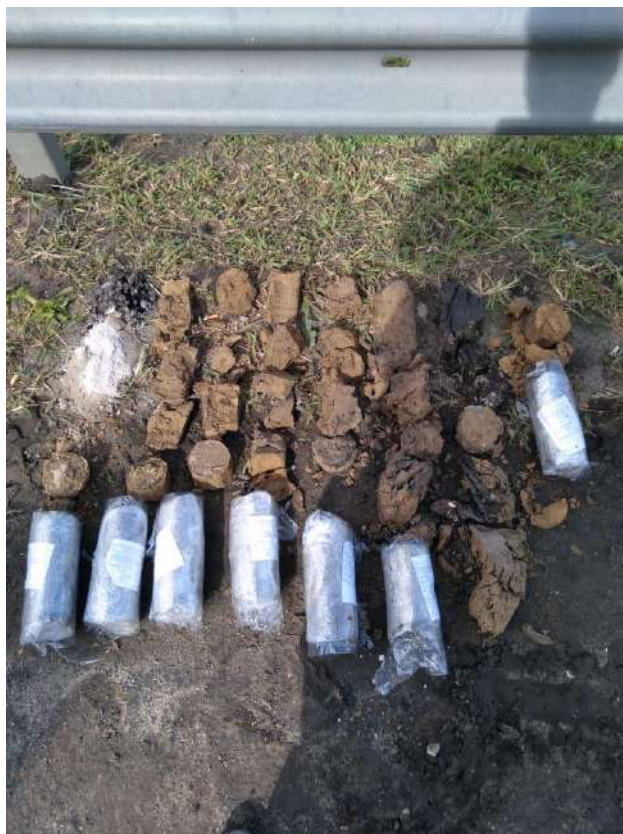
Выкладка керна из скважины осуществлялась с 1 по 8 метр.
