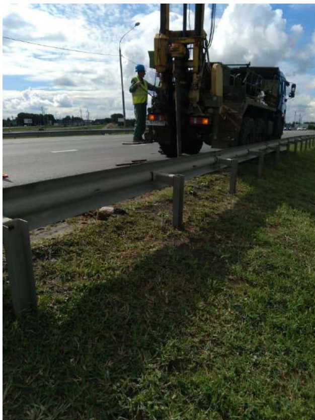
Выкладка керна из скважины осуществлялась с 1 по 8 метр.
