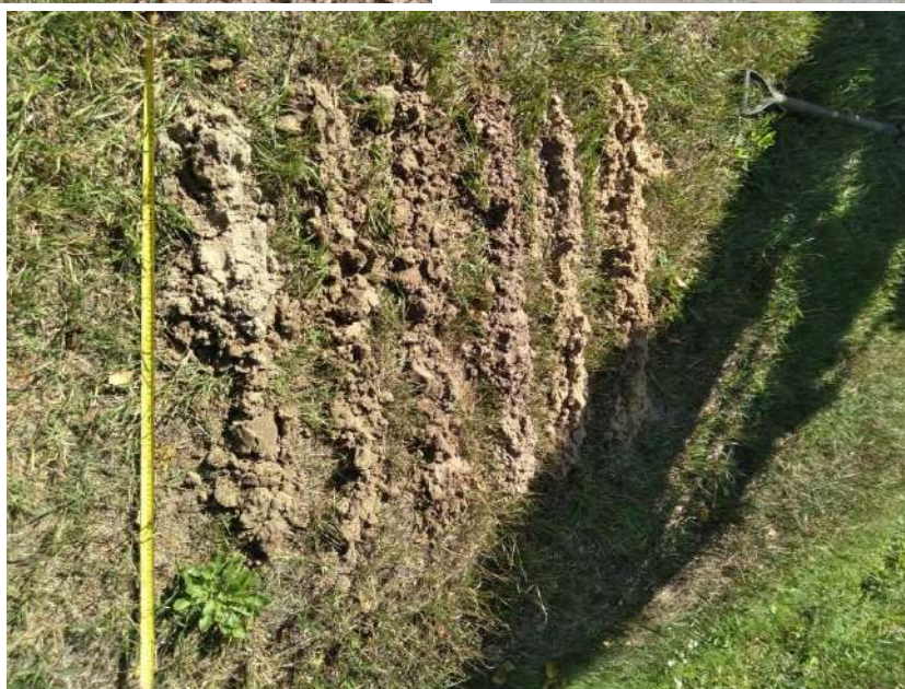
Выкладка керна из скважины осуществлялась с 1 по 6 метр.
