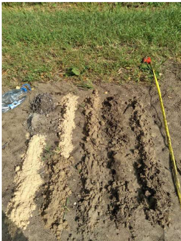
Выкладка керна из скважины осуществлялась с 1 по 5 метр.
