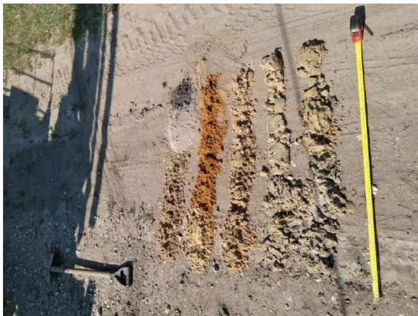
Выкладка керн из скважины осуществлялась с 1 по 5 метр.
